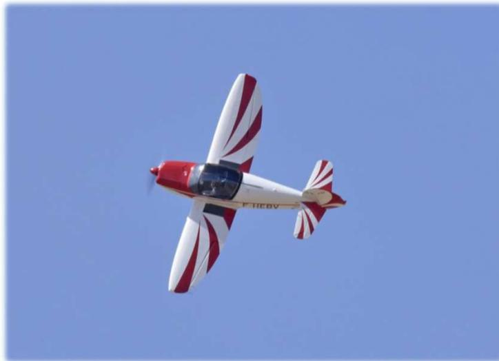
Le CAP 10 C est un avion biplace de voltige avancée, évolution du CAP 10 B, avec une structure renforcée en carbone pour plus de résistance. Doté d'un moteur de 180 chevaux, il offre d'excellentes performances en manœuvres acrobatiques. Sa maniabilité et sa robustesse en font un choix idéal pour l'entraînement et la compétition.
